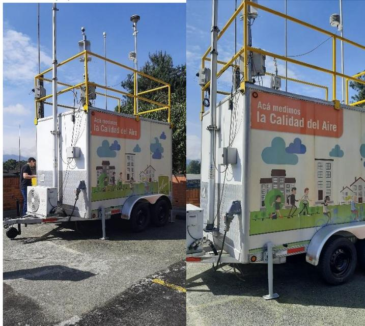
Estación tráiler con equipos de verificación de calidad del aire parque de las aguas
