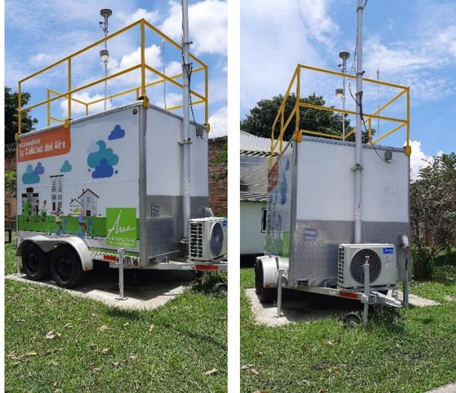
Estación tráiler con equipos de verificación de calidad del aire universidad Luis amigó caldas
