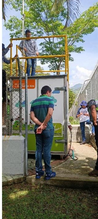
Estación tráiler con equipos de verificación de calidad del aire universidad san buenaventura en Bello
